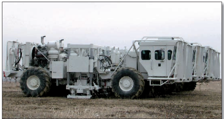
656. Camion-vibreur employé pour l'analyse sismique du sol. (Coll. Déhel)
